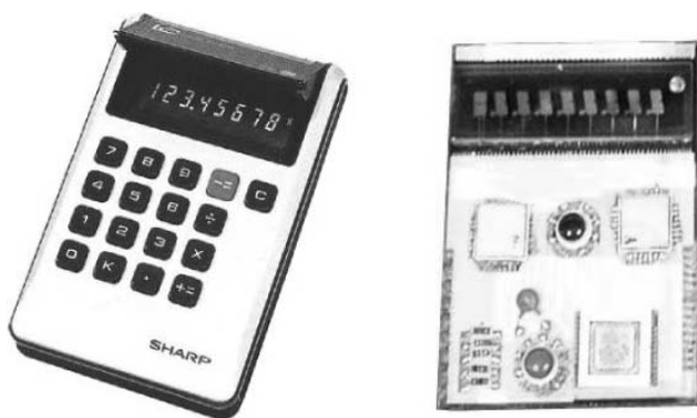
図2 液晶電卓EL-805 (動作表示例とガラス上に実装された CMOS-LSI)
