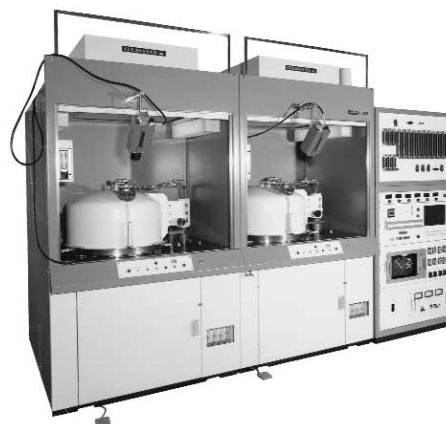
写真2 DC-5200エピ装置外観
