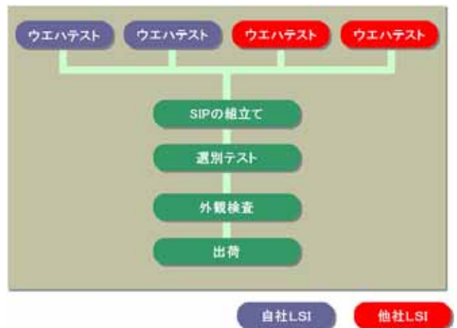
図 5 SiP のウエハ~組立てまでのテストフロー
